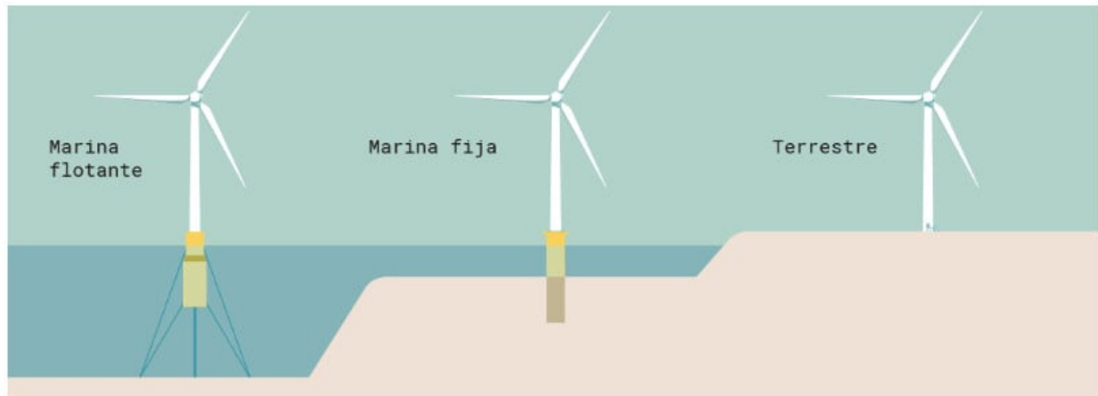
Figura 1.6: Tipos de cimentaciones de aerogeneradores (Fuente: [6])
