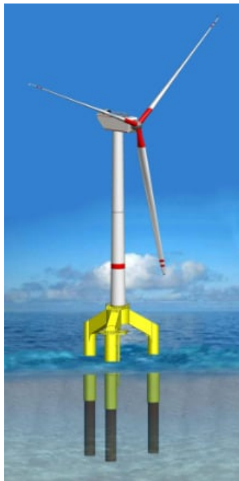
Figura 1.13: Estructura tripilote (Fuente: [9])
