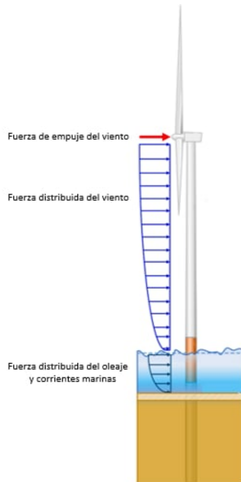
Figura 2.4: Cargas actuantes sobre un aerogenerador offshore (adaptado de [13])
