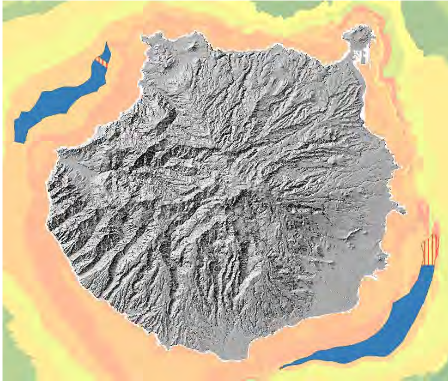
Figura 89: Caracterización del suelo de las zonas propuestas para el desarrollo de la eólica cimentada al lecho marino en Gran Canaria. Fuente: Elaboración propia.
