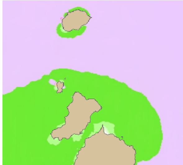
Figura 48: Recurso eólico a 80 m de altura en la isla de La Graciosa. Fuente: Elaboración propia a partir de [9].
